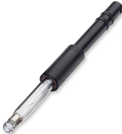
Der ORP-Sensor von Hydrolab arbeitet mit einem Platinband, das Elektronen aufnimmt oder abgibt. So können chemische Reaktionen beobachtet, die Ionenaktivität bestimmt oder die oxidierenden bzw. reduzierenden Eigenschaften einer Lösung ermittelt werden.
